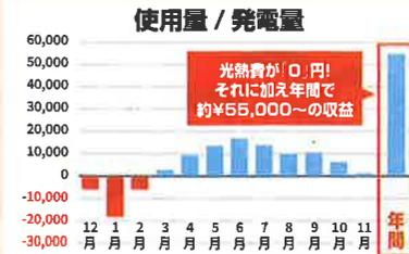
※売電開始2020.12~(21円/kwh)、発電量5.2KW。(京セラ、パナソニック)屋根南向き緩勾配(上越市) データは条件によって異なります。
